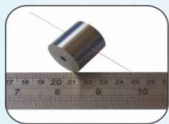
曲面加工 材質:模具鋼 L=18mm Φ=0.2mm
